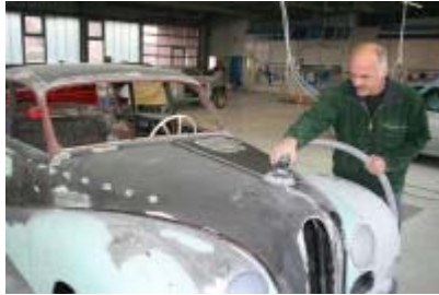
Wie bei einer sanften Massage rückt Georg Lorenz den 49 Jahre alten BMW 502 V8 mit der Schleifmaschine auf die Pelle.
