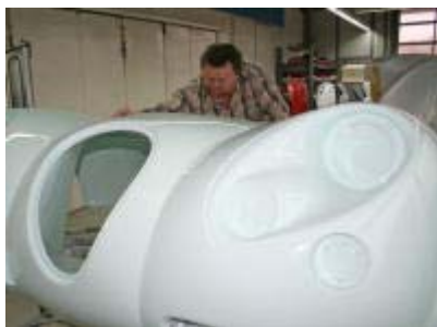
Sorgfältig poliert Harald Bolzenburg das fertig lackierte Frontstück einer Wiesmann-Karosserie.
